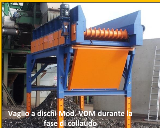
Vaglio a dischi Mod. VDM completo di sottostruttura regolabile
