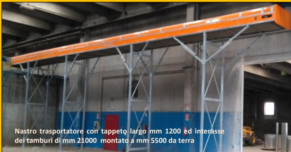
Nastro trasportatore con tappeto largo mm 1200 ed interasse dei tamburi di mm 21000 montato a mm 5500 da terra
