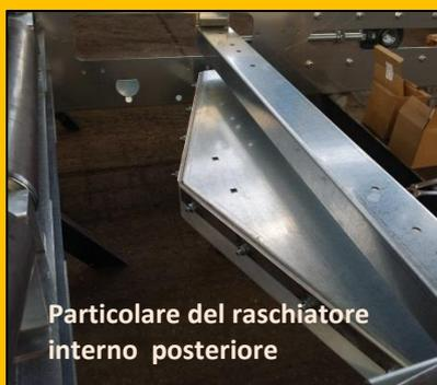
Particolare del raschiatore interno posteriore
