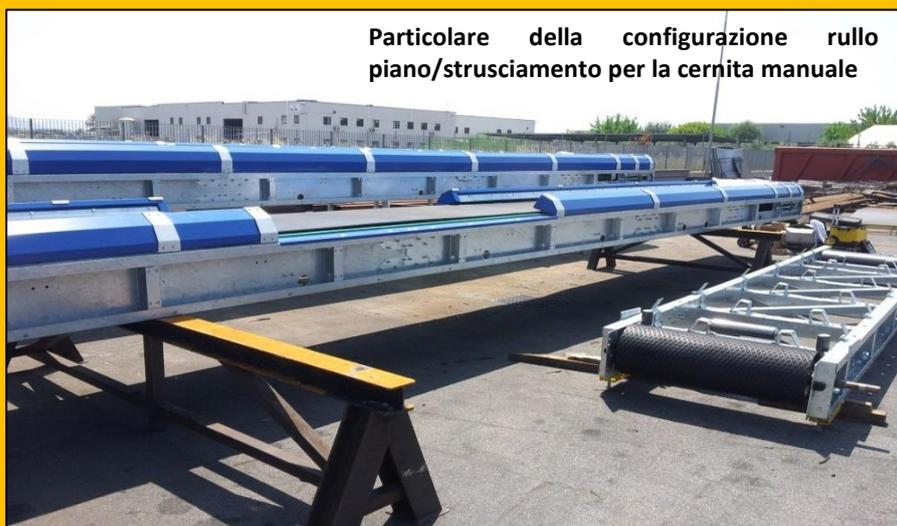
Particolare della configurazione rullo piano/strusciamiento per la cernita manuale
