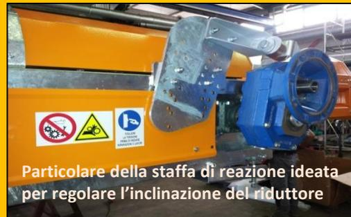
Particolare della staffa di reazione ideata per regolare l'inclinazione del riduttore
